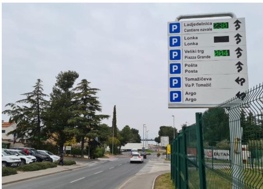
Slika 33: Primer elektronskega vodenja do prostih parkirišč v Izoli
