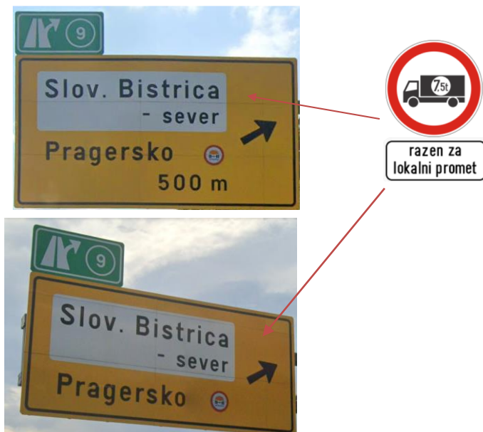
Slika 10: Dodatni znak na predkrižiščnih tablah za izvoz »Slov. Bistrica – sever« iz smeri Maribora.
