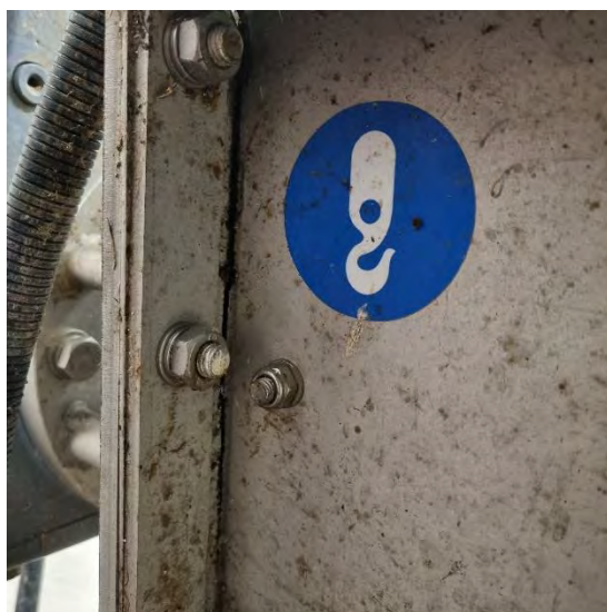
Zlom ohišja kompaktorja
